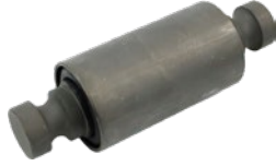
37 - Buje: Buje muelle delantero - SAMPA - 500-594
